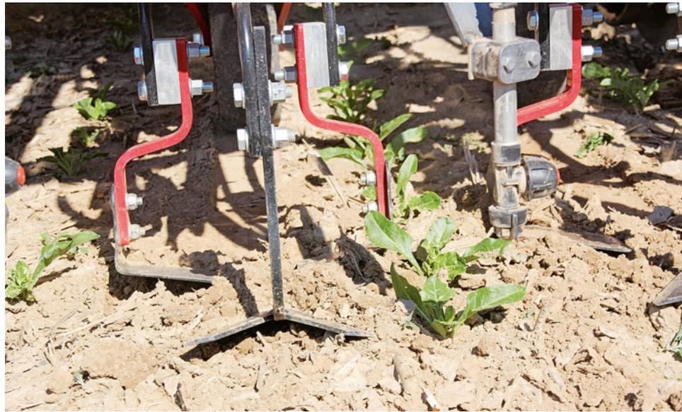
Einzelne Hersteller ermöglichen auf Wunsch auch die Ausrüstung der Hackmaschinen mit einer Bandspritze. Fotos: LIZ
