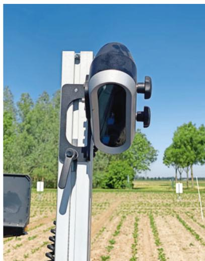
**Um sicher möglichst nah an die Rübe zu kommen, setzen die Hersteller in der Regel auf eine oder zwei Kameras, die mehrere Rübenreihen im Blick haben.**
