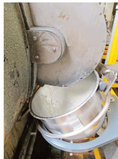
Nach dem Waschen werden die Rüben mit der Breisäge in einer festgelegten Zeit angesägt und zu einem feinen, gleichmäßigen Brei verarbeitet.
